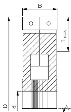
Набор фрезерных головок с регулировкой **GR** со сменными режущими пластинами и с подрезными боковыми (правыми и левыми) ножами – это насадные головки с соответствующим количеством зубьев предназначены для профессиональной обработки дерева и других древесных материалов, таких как ДСП, MDF и других. Набор служит для чистовой выборки пазов и для фальцовки. Регуляция обрабатываемой ширины осуществляется с помощью прокладок с шагом 0,1 мм. Корпус головок может быть как стальной, так и алюминиевый.
