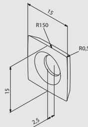
Размеры режущей пластины
