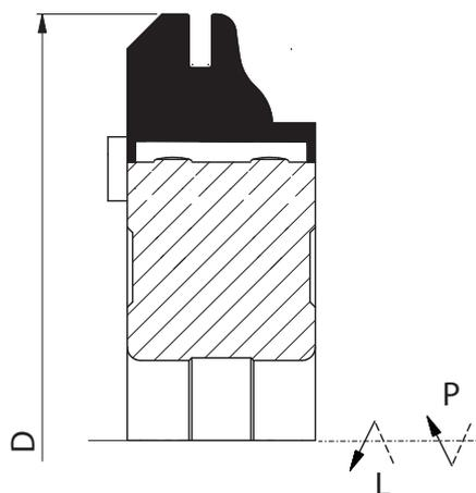
Фрезерная головка **1100-1** со сменными режущими пластинами – это насадная головка с соответствующим количеством зубьев предназначена для профессиональной обработки дерева и других древесных материалов, таких как ДСП, MDF и других. Головка применяется для обработки плоских поверхностей. Корпус головки может быть как стальной, так и алюминиевый.
