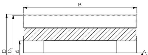
Фрезерная головка **1100-4** – это насадная прямая головка со сменными ножами с соответствующим количеством зубьев предназначена для профессиональной обработки древесины. Головка служит для обработки плоских поверхностей. Регулировка высоты режущих ножей осуществляется с помощью пружин. Головка приспособлена для снятия неровностей в материале высотой до 5 мм для черновой обработки и 0,8 мм для чистовой обработки. Корпус головки может быть как стальной, так и алюминиевый.
