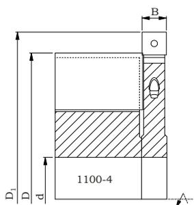
Фрезерная головка **G103** – это насадная прямая головка со сменными режущими пластинами с двумя прямыми резами и двумя подрезными, левыми или правыми ( $z=2v2$ ), предназначена для профессиональной обработки древесины. Головка служит для форматирования торца обрабатываемого материала. Специальная геометрия позволяет применять ее в комплекте вместе с прямыми головками 1100-4. Корпус головки может быть как стальной, так и алюминиевый.
