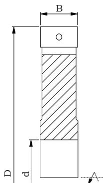
$D_{max} = 400 \text{ mm}$ ,  $B_{max} = 120 \text{ mm}$
