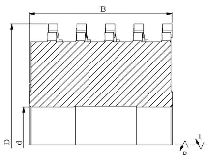
Фреза **FS-01** – это насадная спиральная фреза с увеличенным количеством зубьев предназначена для профессиональной обработки дерева и других древесных материалов, таких как ДСП, MDF и других. Фреза служит для чистовой обработки плоских поверхностей материала с большим количеством сучков или материала с разным направлением волокон. Фреза приспособлена для снятия неровностей в материале высотой до 4 мм.
